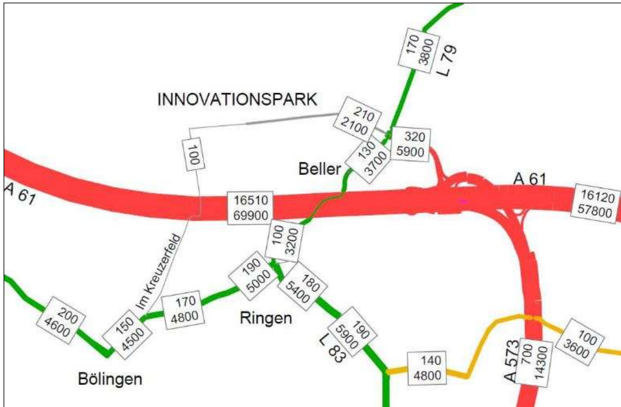
Abb. 10 Verkehrsbelastungen Analyse DTWv 2014 (Angaben in SV/24h und Kfz/24h)
